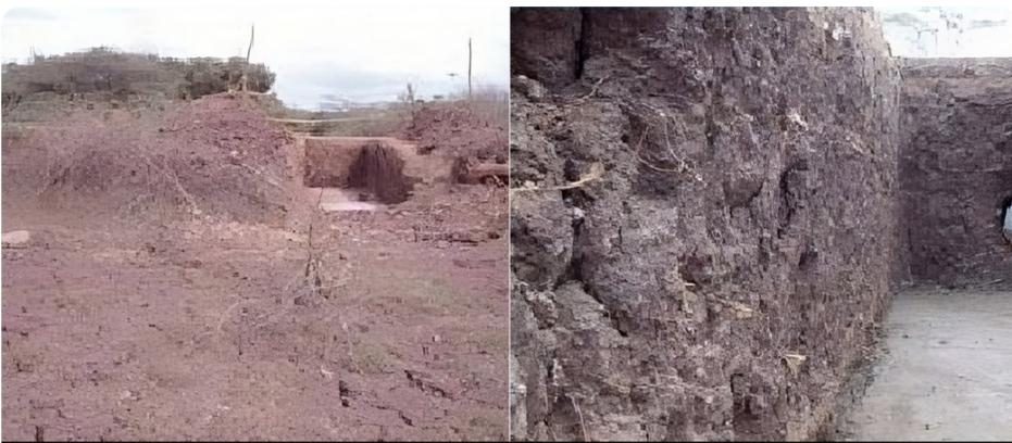
Fotografía 1 y 2. Material constituyente del terraplén existente (ver presencia de grietas y raíces).
